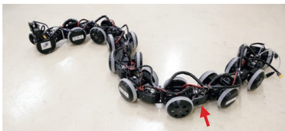
ヘビ型ロボット T2 Snake-3 SEED MSは各関節の側面に内蔵(矢印部)
