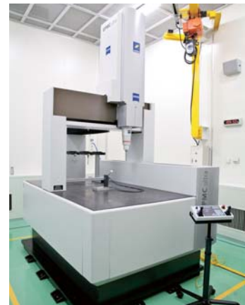
免震装置付き三次元測定機
