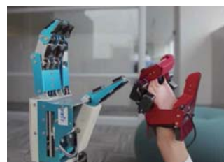
ロボットグローブの動きに連動して同じ動きをするJAXAハンド
