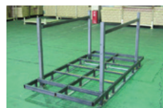
再利用するスキッドパレット
