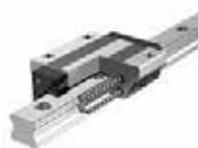
第二世代のLMガイドとして開発。ボールを保持するリテーナの採用により、従来のLMガイドに比べて長寿命、低騒音、長期メンテナンスフリーを実現した製品です。
