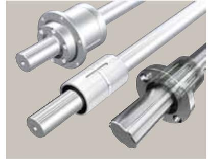
ボールスプラインは、1971年、THK創業の年に開発され、LMガイドの原点となった製品です。軸に設けられたR形状の溝をボールが転がることで、許容荷重が大きくなり、かつトルク伝達が可能となった、それまでにない画期的な直線運動案内部品です。従来の構造に比べて、許容荷重は13倍に増加し、寿命は2,200倍にもなりました。さらに高機能化を果たした現在では、産業用ロボットや医療機器、チップマウントなど様々な機械に使用されています。
