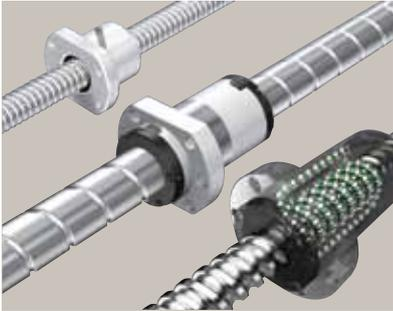
ボールねじは、ねじ軸とナットの間に多数のボールを循環させることで、回転運動を直線運動へ効率的に変換する機械要素部品です。「ボールリテーナ入りボールねじ」は従来のボールねじにボールリテーナを採用することにより、長寿命、低騒音、長期メンテナンスフリーを実現しました。そのため今日の工作機械や産業用ロボット、半導体製造装置などに必要不可欠な要素部品となっています。THKでは、油圧シリンダからの置き換えに最適な高負荷対応のボールねじも取り揃えており、射出成形機やプレス機、ダイカストマシンなどに採用されています。
