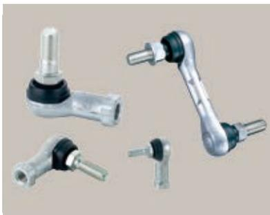
THKは創業期からLMガイドと並ぶ製品として、アルミ製の自動車の足回り部品であるリンクボールを有しています。リンクボールは、球面部に高精度の軸受鋼球を使用し、ダイカストでホルダを成形した後シャック部を特殊溶接する、独自の製法により作られています。アルミダイカスト一体型の成形により、高い耐食性、耐摩耗性を発揮し、従来のスチール製品と比較して大幅な軽量化を可能としています。世界中の大手自動車メーカーにおいて、自動車のスタビライザーとサスペンションを繋ぐジョイント部分や車高センサーなど、足回り機構に数多く採用されており、自動車の安全性や快適性の向上に貢献しています。
