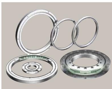
クロスローラーリングは、内部に円筒ころが直交に配列されており、あらゆる方向からの荷重に耐えることができます。さらに、直交配列したローラーの間にスペーサリテーナを組み込むことにより、ローラーのスキュー（たおれ）やローラー同士の相互摩擦を防止しています。コンパクトな構造ながらも高剛性を有し、産業用ロボットの関節部や旋回部、マシニングセンタの旋回テーブル、マニピュレータ回転部、精密ロータリーテーブル、医療機器、計測器、半導体製造装置など、各種機械の回転部分に使用されています。
